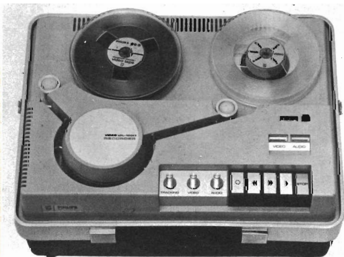
Fig. 1 - Videoregistratore portatile mod. LDL 1000 dotato di una robustissima custodia in resina antiurto. (Documentazione Philips)
